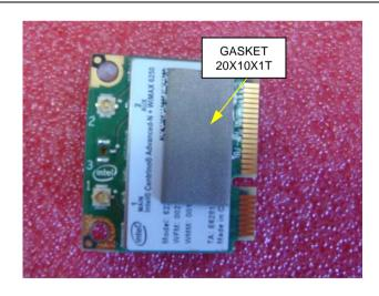
Remove GASKET 20X10X1T from WLAN CARD.
